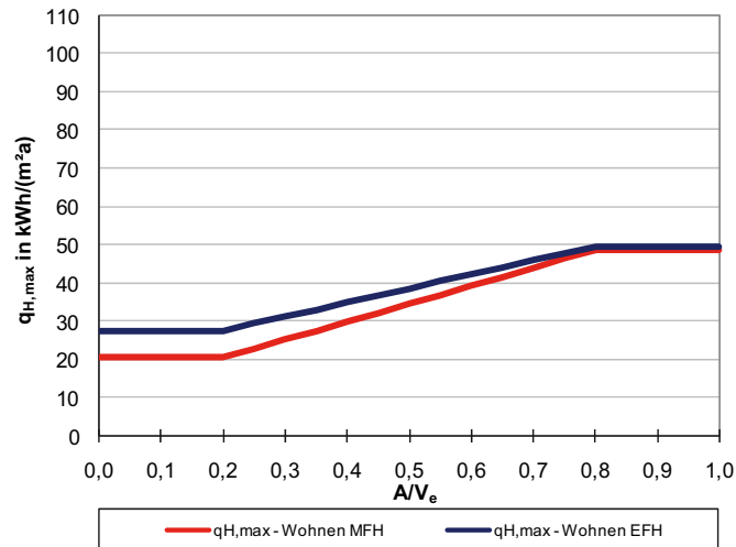
Abbildung 2c - Anforderungen an den spezifischen Heizwärmebedarf für Wohngebäude, deren Baugenehmigung ab dem 1. Januar 2015 und bis zum 31. Dezember 2016 beantragt wird
